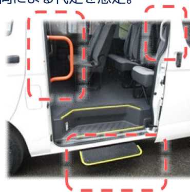
電動ステップや手すりを設置
