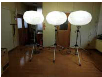
新たに設置されたLEDバルーン投光器。
