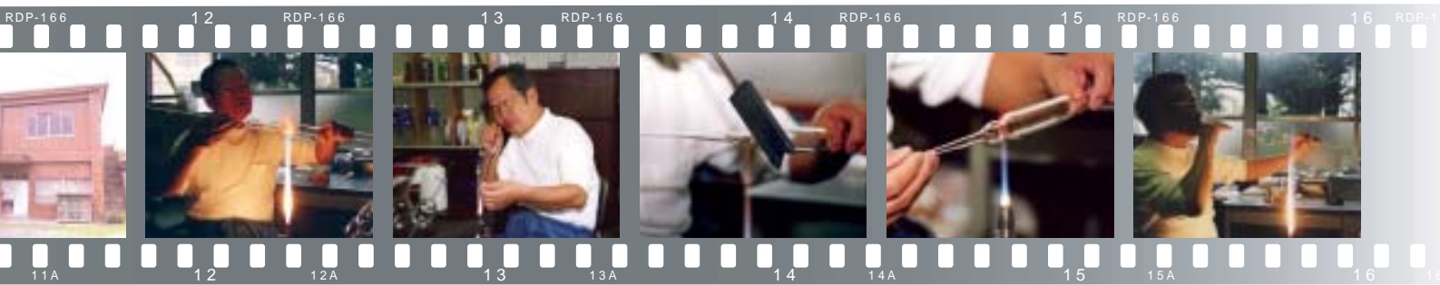
11A 12 12A ガスバーナーの温度や火をあてる位置を微妙に調整しながら作業。
